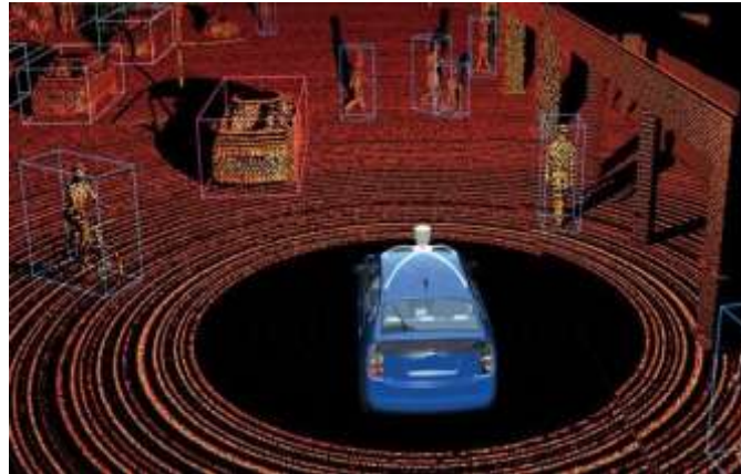
Σχήμα 8: Ανίχνευση Αντικειμένων με την χρήση LIDAR τεχνολογία. [18]
