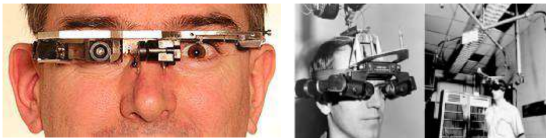
Εικόνα 1: Το EyeTap (αριστερή εικόνα) και Sword of Damocles (δεξιά εικόνα)
